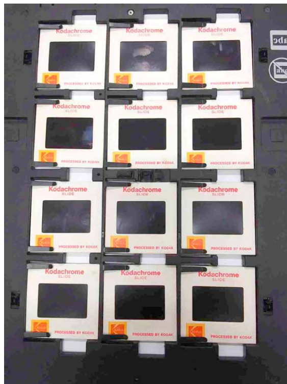
Fig. 36. Diapositivas colocadas en plantilla para su digitalización.
