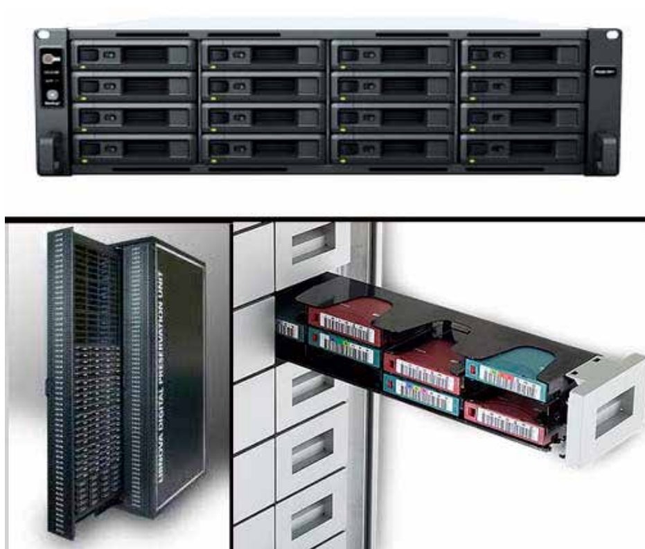
Fig. 85. Cabinas para preservación. Arriba: cabina Synology. Abajo izq.: sistema LibData. Dcha.: cabina de cintas magnéticas.
