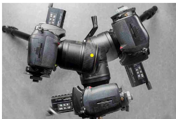
Fig. 60. Giro de la cámara montada en la rótula sobre el punto nodal.
